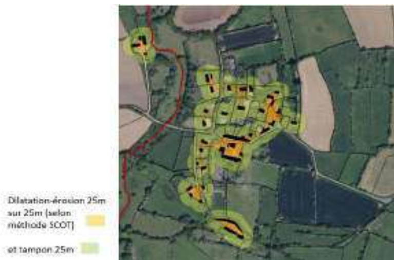
Exemple de dilatation-érosion et de tampon 25 m
